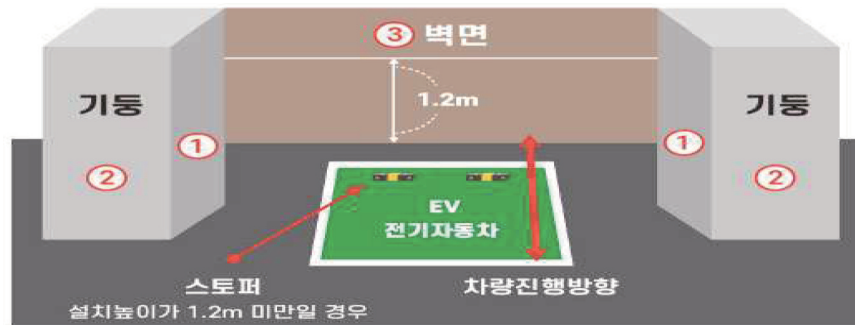
과급형 콘센트 설치위치에 따른 방호장치 시설
